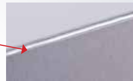
Die Lichtbogenfokussierung ist deutlich zu erkennen
