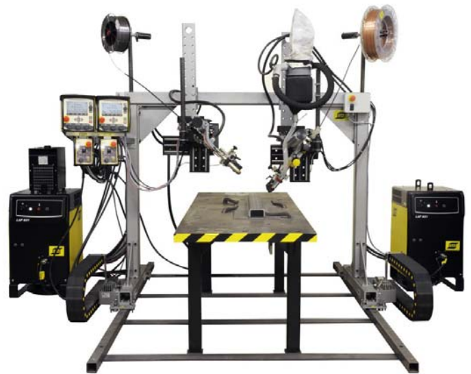
Mechtrac ausgerüstet mit zwei A2 Schweißköpfen, Prozesssteuereinheiten PEK und Schweißstromquellen LAF 631
